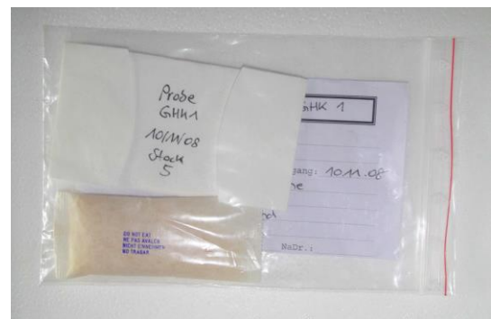
Abb. 3: Ziplock-Beutel 3 zur Aufbewahrung von Haarproben mit Filterpapier 7 , Trocknungsmittel 4 und Probenbeschriftung.
