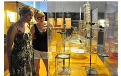
So sah es im Labor aus: Eine Destillationsapparatur als Gerät für thermische Trennverfahren
