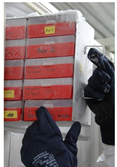
Lagersystem für Proben, die bei -80°C tiefgefroren werden. Foto: S. Tränkner/Senckenberg
